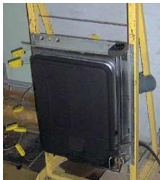
Figura 1a): Cámara del calefactor recubierta con pintura negra.
