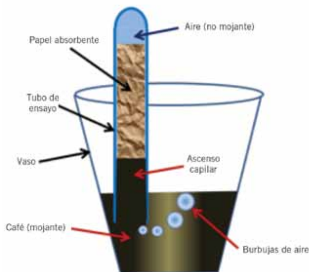
Figura 1. Experimento simple de imbibición en contracorriente. El café (fase mojante) “trepas” por el papel absorbente (medio poroso) desplazando el aire (fase no mojante) de sus poros. Cuando la presión dentro del tubo de ensayo es suficiente, el aire percola por el papel, burbujeando por la parte inferior del tubo de ensayo.
