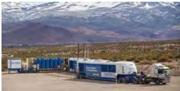
emblemáticos de Galileo. Cada unidad es apta para área C1.D2. cuenta con compresor recíprocante MX 200® de dos etapas, motor a gas de 118 hp y sistema de reinyección de líquidos.
