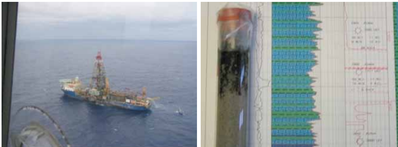
Buque perforador en la locación del prospecto Peroba (offshore profundo de la cuenca de Campos) poco antes de aterrizar. Log con el intervalo perforado con muestra de petróleo (carbonatos de la F. Macaé)
