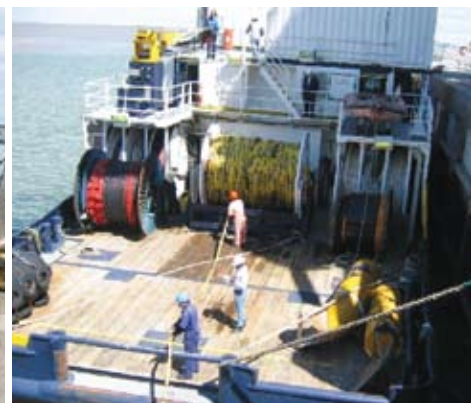
Figura 1 (izq.). Carga de cables sísmicos a un buque de apoyo sísmico. Figura 2 (centro). Comienzo de la operación de desenrollado de cables a riel hidráulico a bordo del buque de apoyo. Figura 3 (der.). Enrollado de cables en el riel hidráulico a bordo. En altamar, estos cables serán traspasados al buque sísmico.
