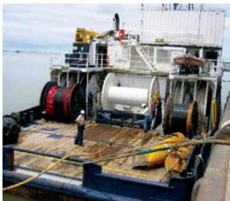
Figura 1 (izq.). Carga de cables sísmicos a un buque de apoyo sísmico. Figura 2 (centro). Comienzo de la operación de desenrollado de cables a riel hidráulico a bordo del buque de apoyo. Figura 3 (der.). Enrollado de cables en el riel hidráulico a bordo. En altamar, estos cables serán traspasados al buque sísmico.
