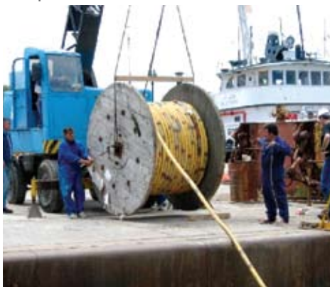
Figura 1 (izq.). Carga de cables sísmicos a un buque de apoyo sísmico. Figura 2 (centro). Comienzo de la operación de desenrollado de cables a riel hidráulico a bordo del buque de apoyo. Figura 3 (der.). Enrollado de cables en el riel hidráulico a bordo. En altamar, estos cables serán traspasados al buque sísmico.
