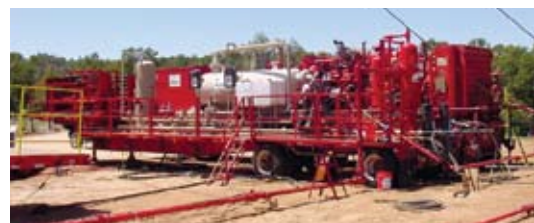
Figura 2. Equipo portátil para terminaciones. Fuente: Weatherford
