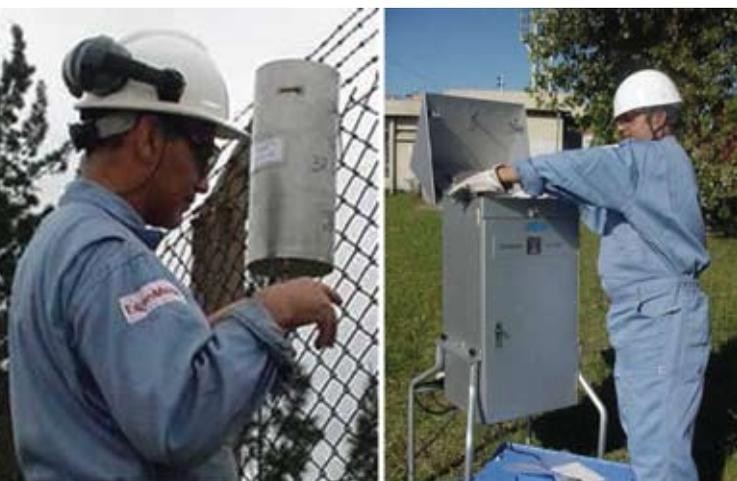
Izquierda: El programa de monitoreo de material sedimentable cubre varios puntos en el perímetro de la refinería.
