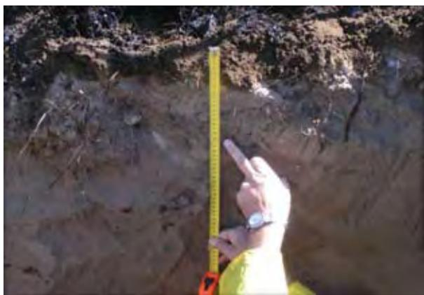
Calicata construida para medir la profundidad de infiltración del petróleo derramado.
