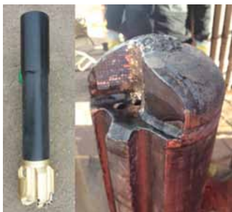
Figura 5. Fresas utilizadas y estado final.
