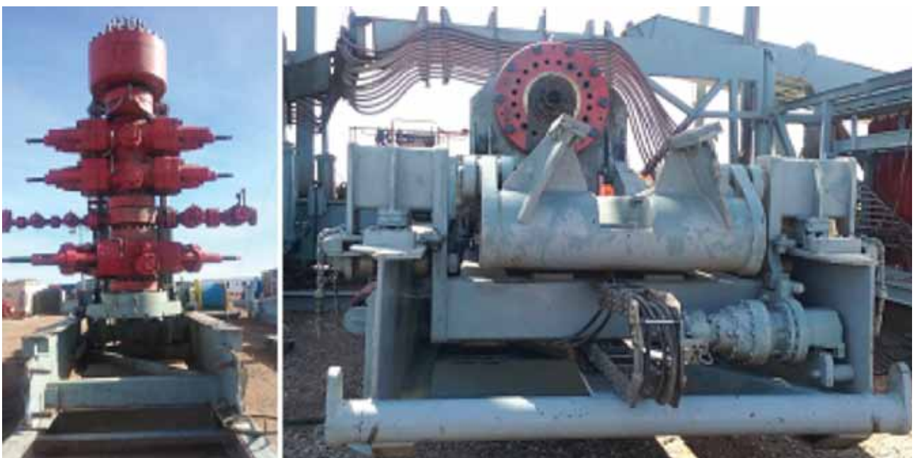
Figura 9. Test stand con BOP en las diferentes posiciones.
