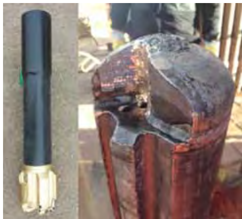
Figura 5. Fresas utilizadas y estado final.
