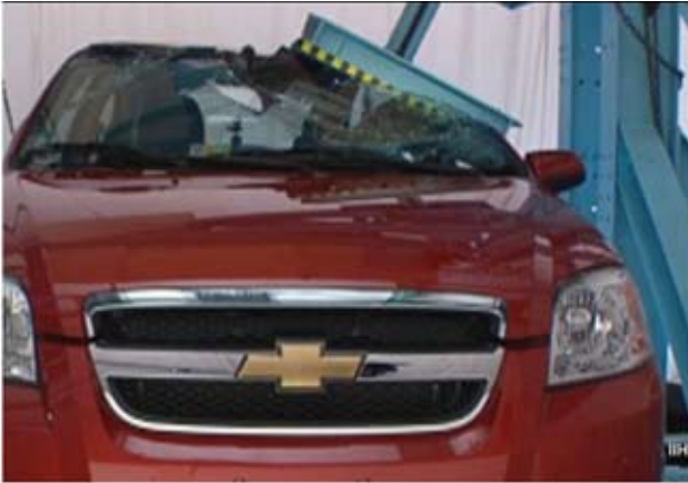
Figura 2. Deformaciones en el techo que generan lesiones importantes al ocupante
