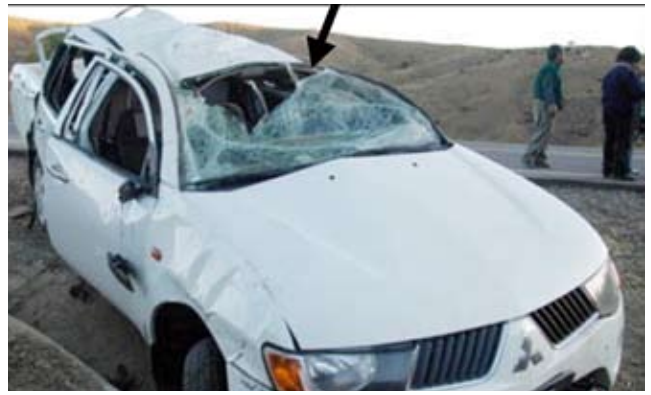
Figura 13 b. Si bien la deformación del techo es importante, según el ángulo de la fotografía, es similar a las deformaciones con barra externa
