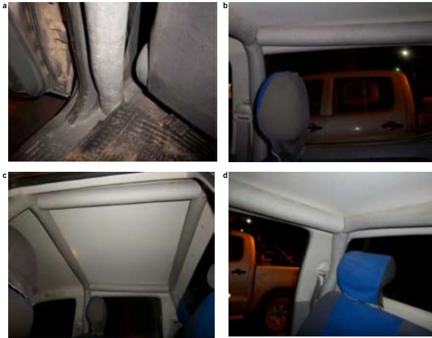
Figura 16. Jaulas internas a. La jaula va fijada al piso de la cabina; b. Posee un revestimiento plástico para amortiguar los impactos; c. Refuerzo de la estructura de parantes centrales y traseros y toda la estructura del techo; d. Jaula con una fabricación heterogénea y que produce una disminución importante del espacio habitable
