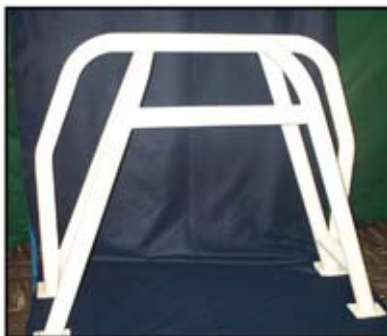
Figura 7. Estructura que se ancla al chasis
