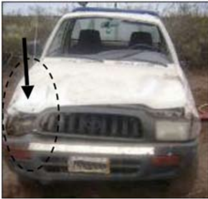
Figura 10. Deformación sobre el ángulo delantero derecho, por el plano de apoyo entre la barra externa y el frente del vehículo
