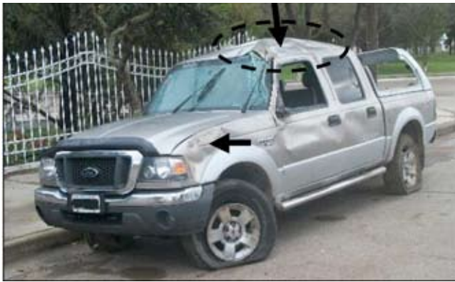
Figura 13 a. Vehículo sin barra externa; vuelco sobre el lateral izquierdo y deformación en el techo provocada en el primer giro
