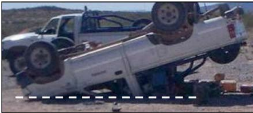
Figura 11.b. Posible consecuencia de tener una barra externa (se repite en distintos vuelcos y vehículos: la barra externa propicia de punto de apoyo y genera un plano con el frente de la camioneta; todo lo que se encuentra entre estos dos puntos se deforma con mayor violencia)
