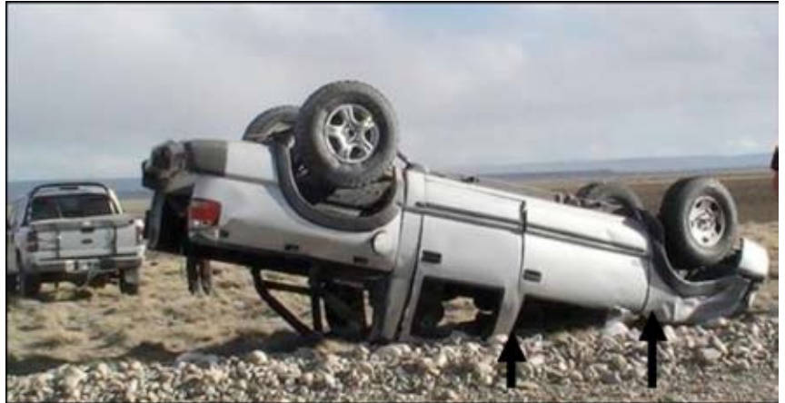
Figura 11.a. Aplastamiento de la cabina desde la jaula o barra externa hacia el frente del vehículo
