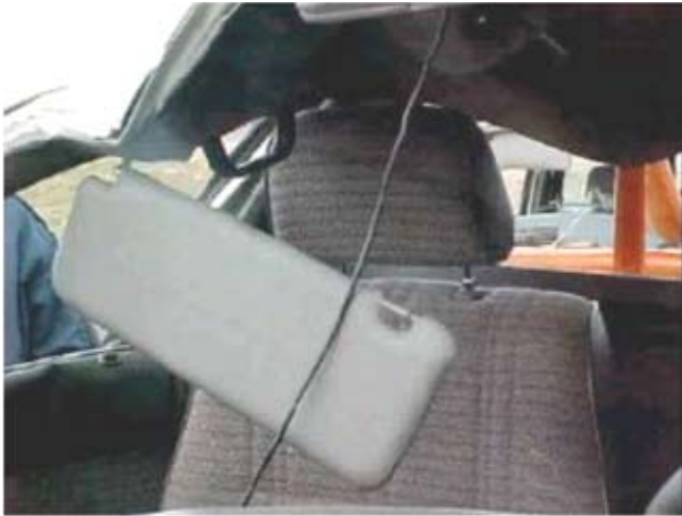
Figura 3. La deformación que se observa en el lateral derecho de la Toyota Hilux provocó serias lesiones al acompañante
