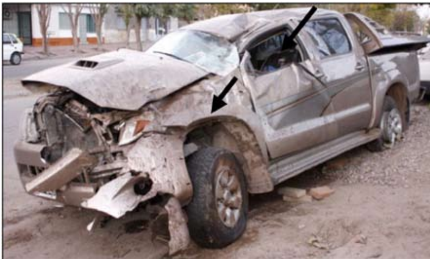
Figura 12. Esta camioneta en particular, y según se deduce de sus deformaciones, realizó varios giros durante el vuelco. Además, se puede apreciar en la parte trasera el desprendimiento de la barra externa
