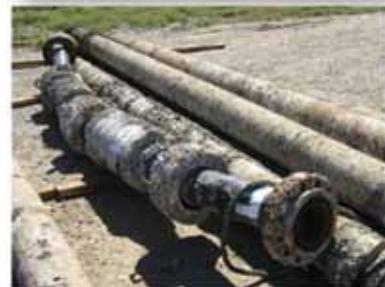
Figura 4. Conexiones móviles: conexión spool-riser (arriba izquierda); spool submarino de conexión entre un segmento reemplazado y el existente (arriba derecha). Empalmes submarinos de un segmento extraído para su reemplazo (abajo).
