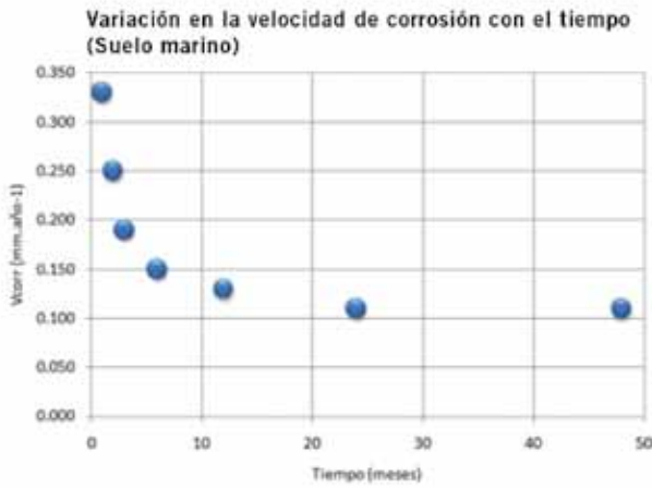
Figura 8. Comportamiento de la tasa de corrosión libre en función del tiempo y de los factores condicionantes (oxígeno-bacterias).
