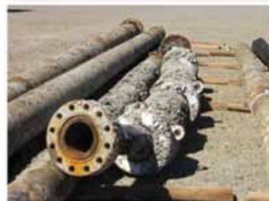
Figura 4. Conexiones móviles: conexión spool-riser (arriba izquierda); spool submarino de conexión entre un segmento reemplazado y el existente (arriba derecha). Empalmes submarinos de un segmento extraído para su reemplazo (abajo).
