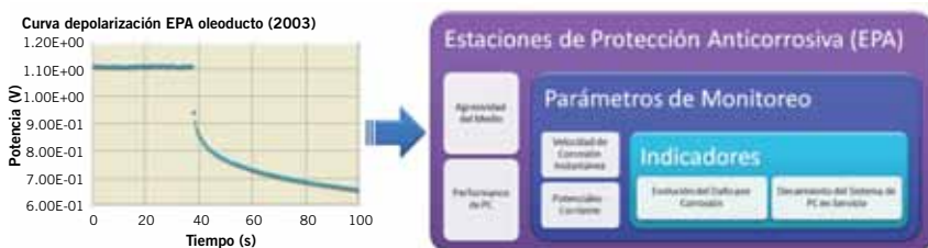
Figura 30. Prestaciones de sensores electroquímicos (corrosión externa).
