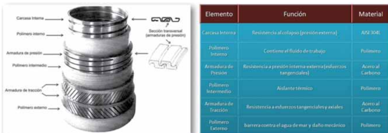
Figura 3. Esquema correspondiente a los flexibles de uso común en aplicaciones offshore.
