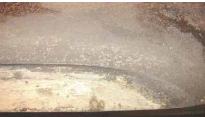
Figura 15. Cupón laminación abierta hacia adentro luego de extraída la escama.
