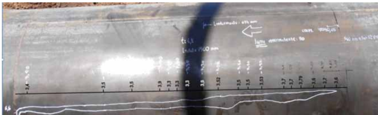
Figura 8. Tramo 3. Laminación paralela.
