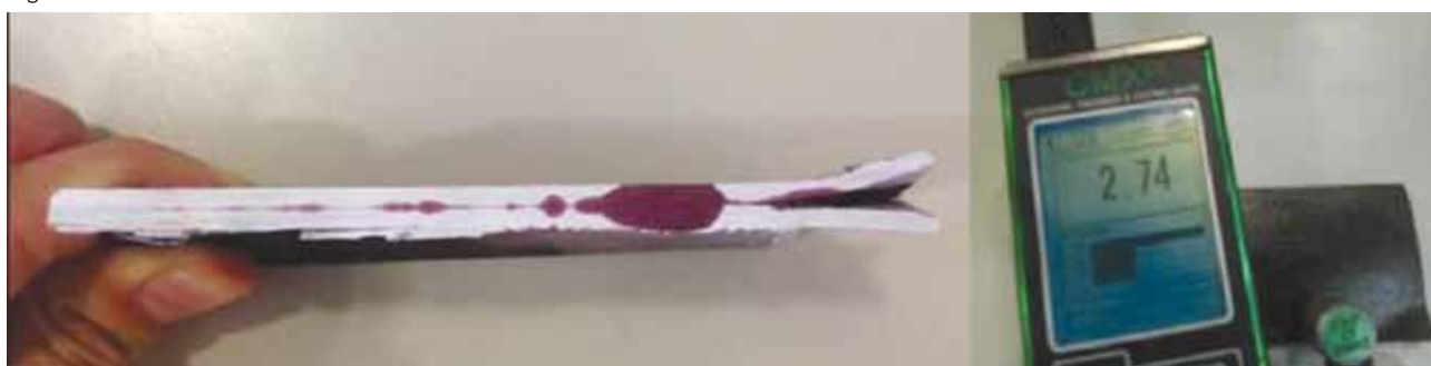
Figura 7. Caracterización del perfil de una laminación paralela con UT.
