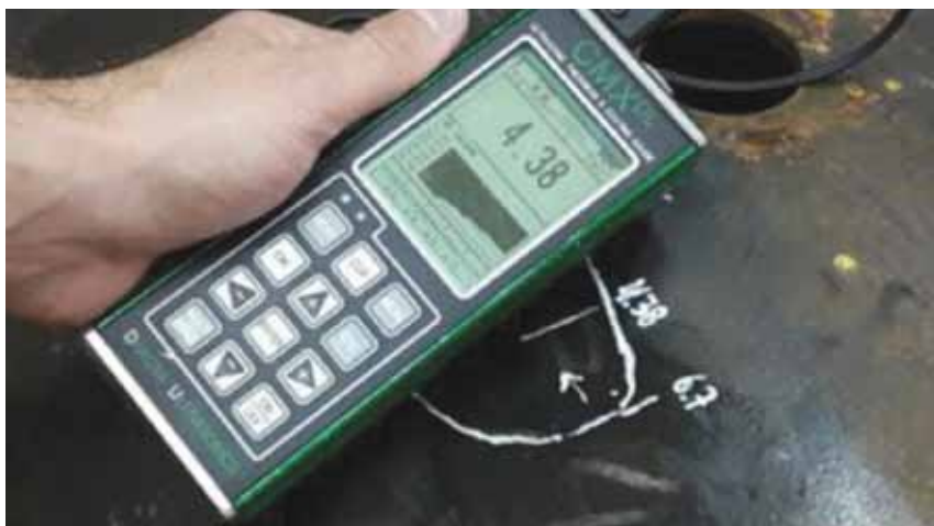
Figura 6. Caracterización de extremo de laminación con UT.
