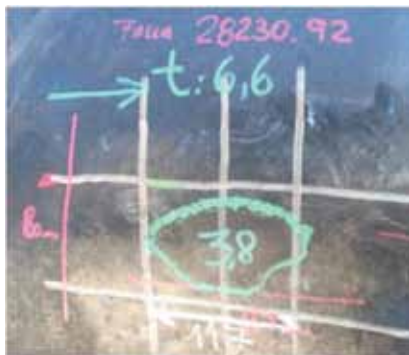
Figura 3. Laminación en tramo 1 abierta hacia adentro.
