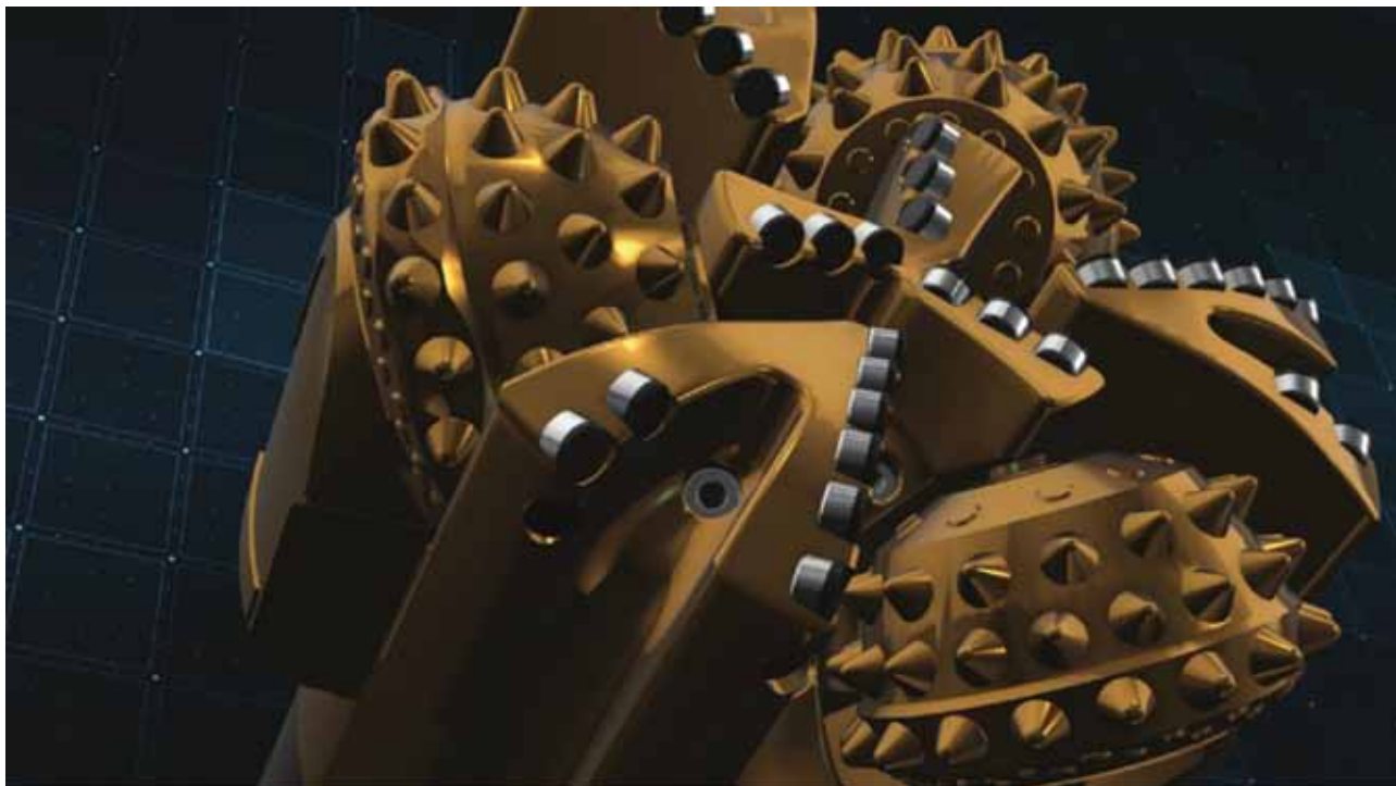
Figura 3. Trépano Kymera Mach 4 de BHGE que está equipado con insertos cónicos de carburo tungsteno con filo en los conos rotativos.
