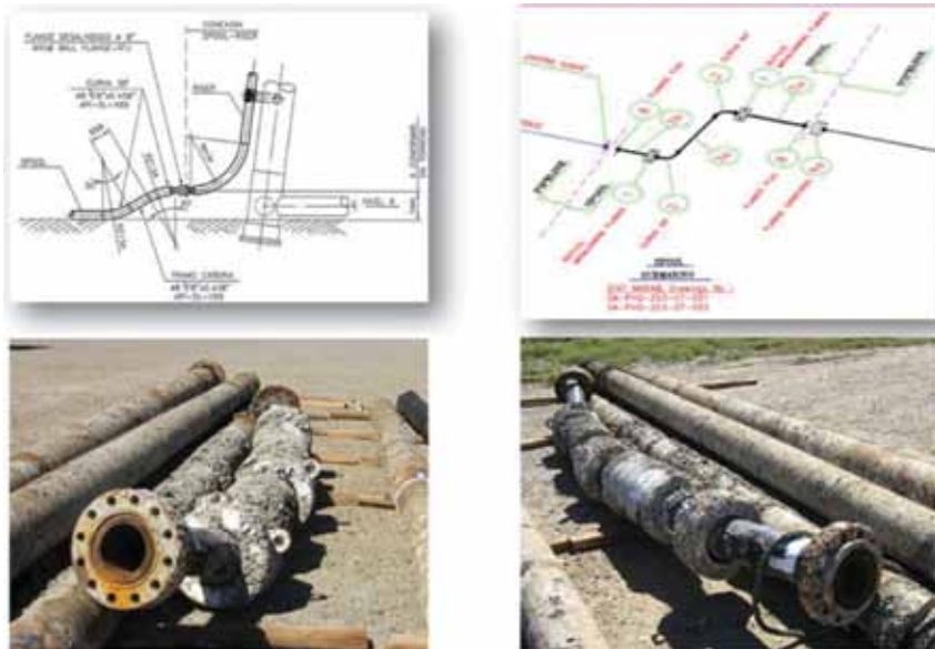
Figura 4. Conexiones móviles: conexión spool-riser (arriba izquierda); spool submarino de conexión entre un segmento reemplazado y el existente (arriba derecha). Empalmes submarinos de un segmento extraído para su reemplazo (abajo).
