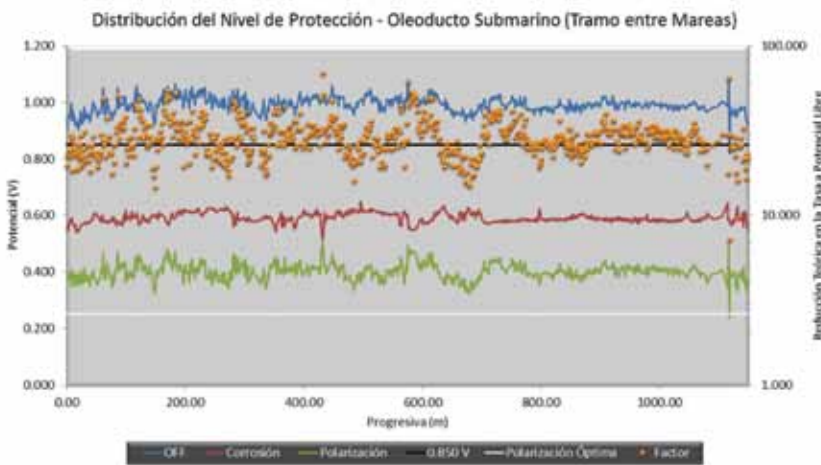
Figura 9. Distribución de parámetros de protección en oleoducto submarino, tramo entre mareas.
