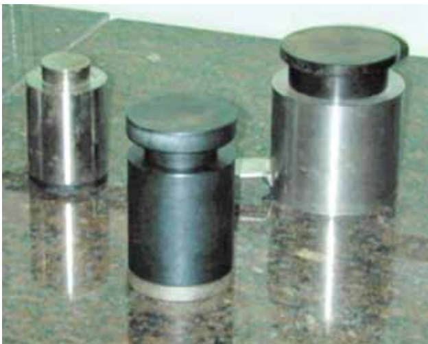
Figura 9. Celdas para el ensayo de resistencia a la rotura, en estas se carga la muestra a ensayar.
