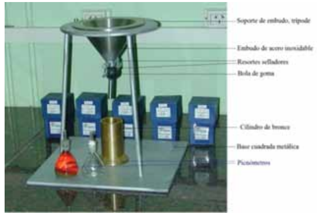
Figura 6. Equipamiento para la determinación de densidad bulk y densidad aparente. En negro se tiene el equipo necesario para la densidad bulk y, en azul, para la densidad aparente. En este último, se advierte el aspecto de un picnómetro con kerosene, conteniendo la muestra ensayada en el fondo.
