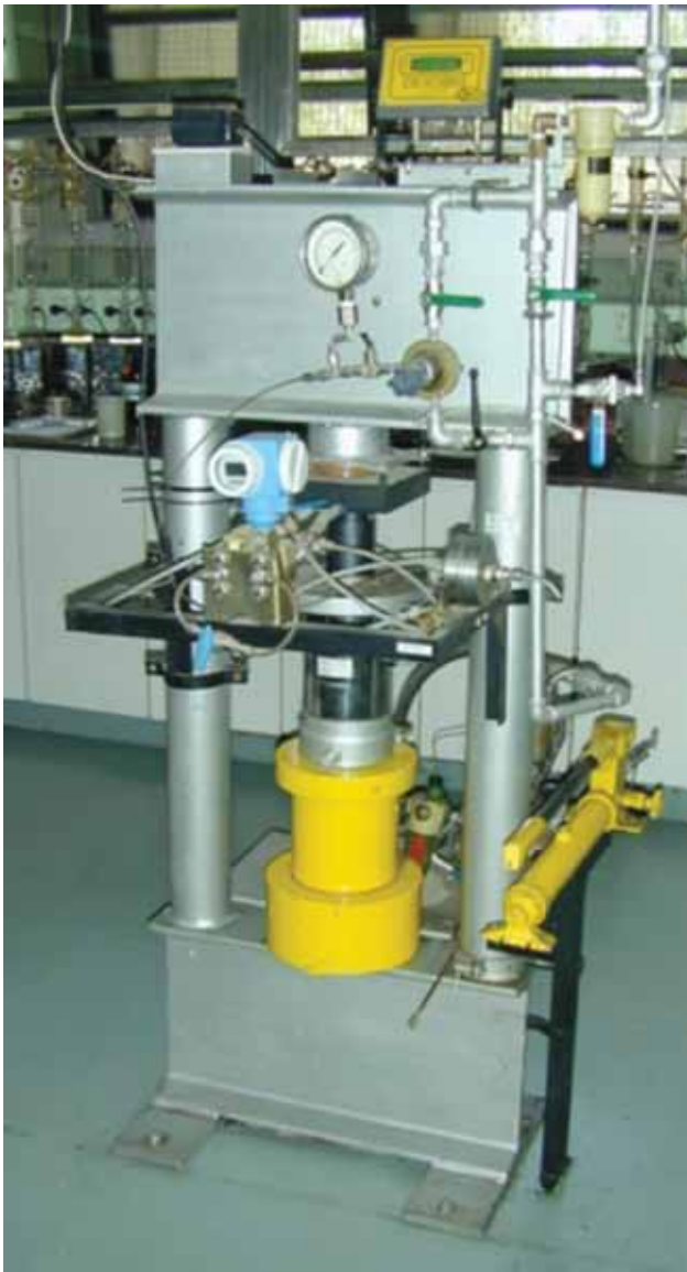
Figura 8. Vista general de la prensa de carga hidráulica. Consta de un sistema hidráulico y platos paralelos, entre los cuales se monta la celda con la muestra.
