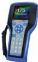
La Edición Silver del Comunicador de Campo 475 provee la dinámica de uso que esperan sus usuarios. Con el lanzamiento de la versión 3.8 del *software*, el Comunicador de Campo 475 ahora puede dar soporte a los controladores digitales HART y FOUNDATION Fieldbus de válvulas mediante la aplicación *ValveLink Mobile*. Con *ValveLink Mobile* los usuarios pueden instalar y calibrar válvulas y correr diagnósticos sobre todo el conjunto de la válvula, en el campo.
