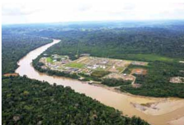
El proyecto consiste en la instalación y operación de dos unidades de recuperación de calor residual en dos turbocompresores de la planta de gas de Malvinas, con el fin de aprovechar el calor residual de la corriente de gases quemados. A partir de este aprovechamiento de calor residual se ha evitado la instalación de hornos para el calentamiento de aceite térmico y, por consiguiente, la quema de combustible adicional.
