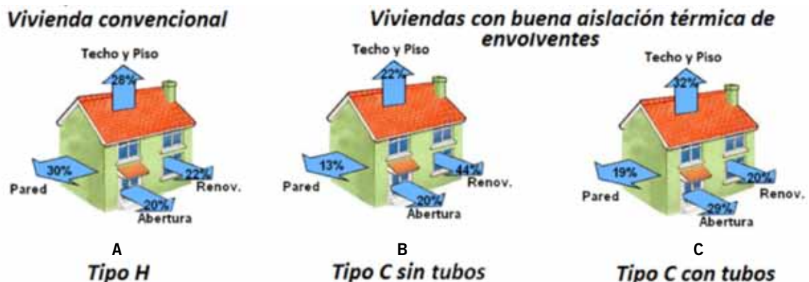
Figura 4. Porcentaje de pérdida de calor por techo y piso, pared, aberturas (ventanas y puertas) y renovación de aire en viviendas. A) Vivienda convencional; B) y C) Viviendas con buena aislación térmica de envolventes, sin tubos y con tubos enterrados, respectivamente.
