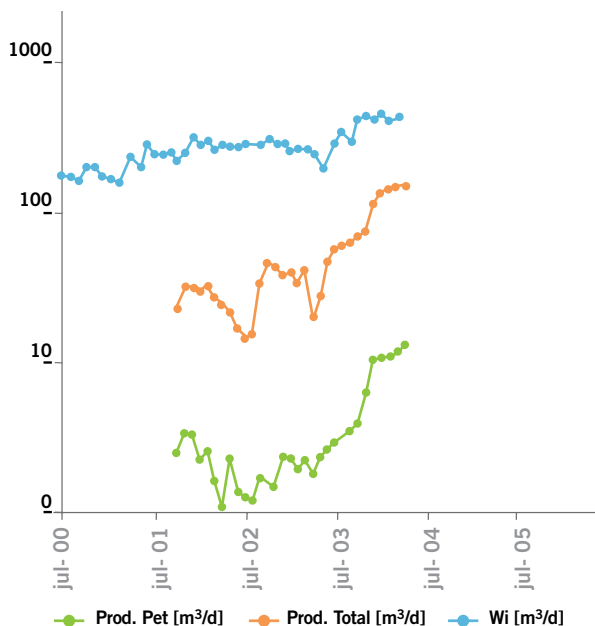
Figura 17. Al comienzo de la producción por inyección de agua, el caudal neto de petróleo es proporcional al caudal bruto de producción. El agua inyectada ( W_i ) corresponde a la suma de todos los inyectores asociados a este pozo productor.
