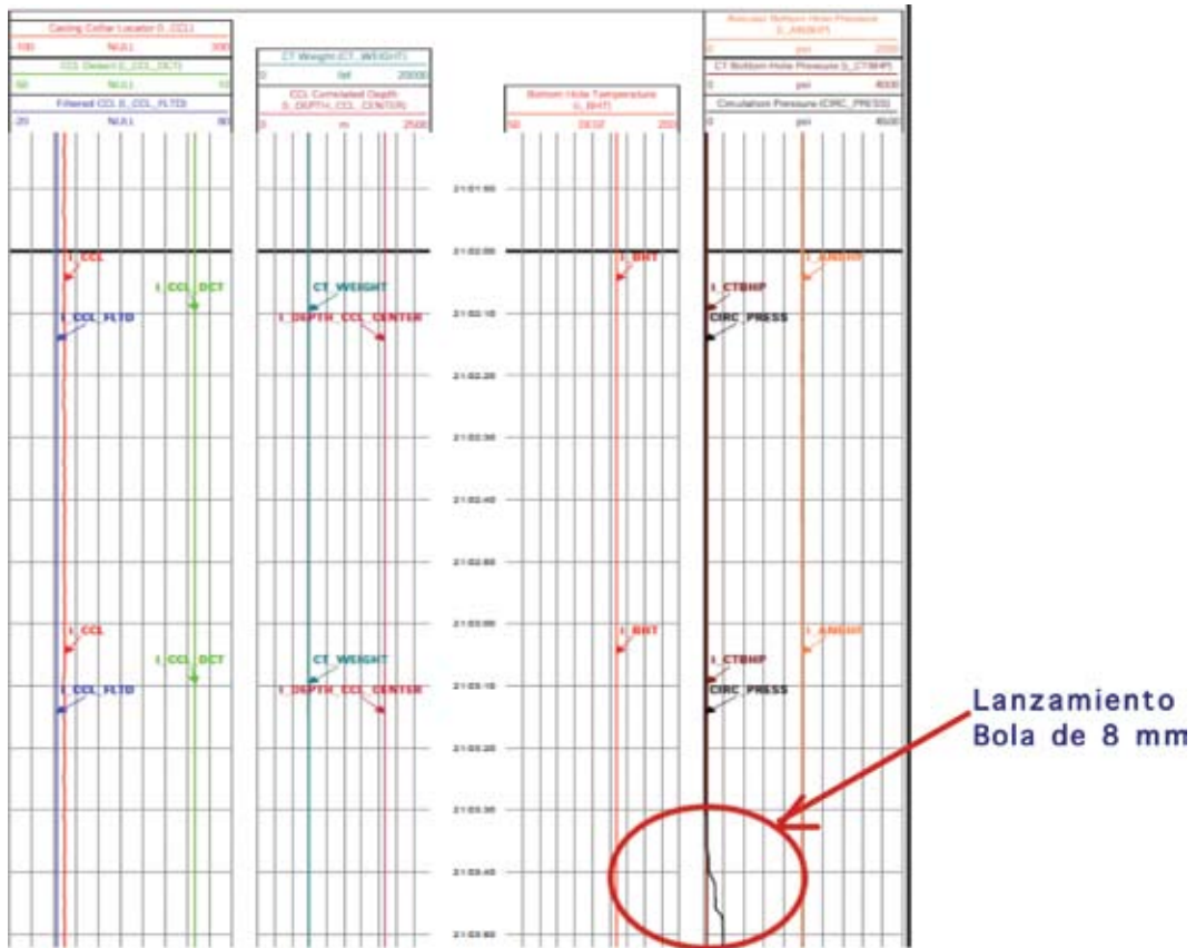
Figura 6. Registro donde se observa el lanzamiento de la bola con la presión de superficie
