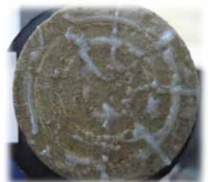
Figura 4. Núcleo de berea - cara de entrada.
