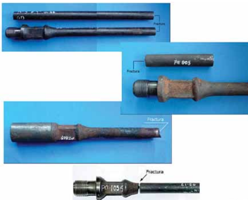
Figura 3. Ubicación de fallas en varillas de bombeo.
