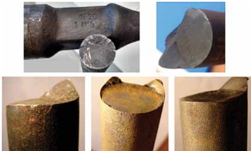
Figura 2. Superficies de fracturas.
