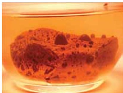
Figura 2. Liberación y desprendimiento de gotas de petróleo en una roca originalmente saturada 100% con dicho fluido.
