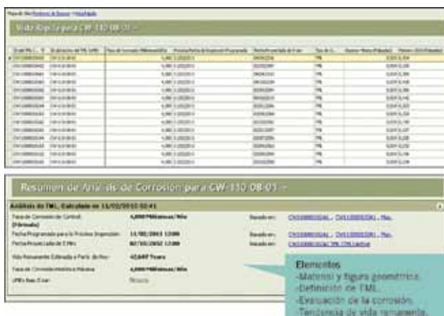
Figura 9. Resultado de un análisis de corrosión.
