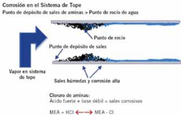
Figura 12. Formación de sales en el sistema de tope ( Overhead system ).
