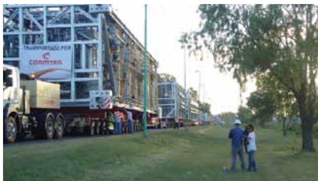
Figura 3. Módulos de la unidad CCR ( Continuous Catalytic Reformer ) - Gentileza Odebrecht.
