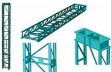
Figura 14. Mallado del tramo superior del mástil.
