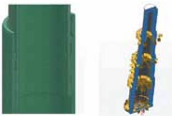
Figura 19. Mallado y Figura 20. Condiciones de borde
