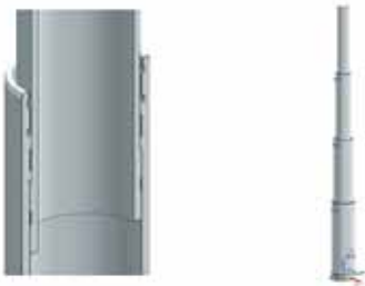
Figura 18. Render del cilindro hidráulico en NX, que muestra camisa, cilindro 1, cilindro 2, cilindro 3 y tapa superior.
