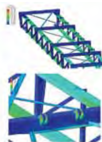
Figura 15. Distribución de tensiones de von Mises en el tramo inferior, zona de elevación (240.000lbs).
