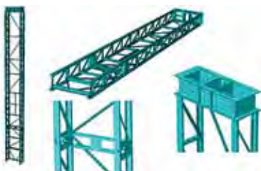
Figura 14. Mallado del tramo superior del mástil.
