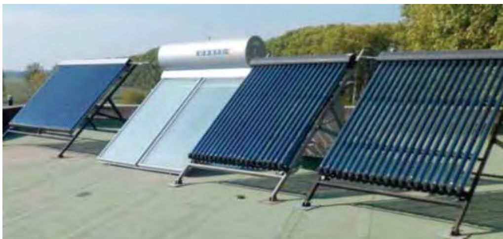
Figura 5. Cuatro colectores solares que se utilizan en el presente ensayo. Como se aprecia, se están ensayando dos tecnologías diferentes de paneles solares: placa plana con cubierta y tubos de vacío (Placco, Saravia, & Cadena, 2007).
