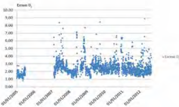
Figura 11. Seguimiento del exceso de O 2 en los gases de chimenea.
