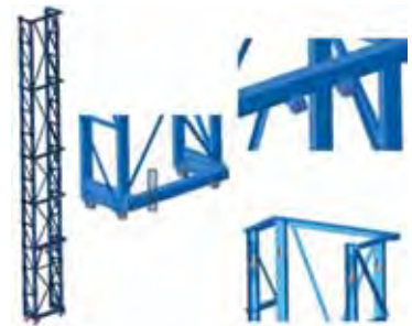
Figura 13. Descripción de las condiciones de carga y apoyo del tramo inferior.
