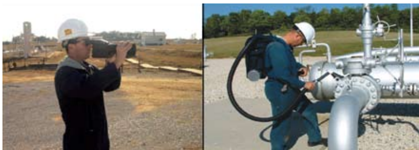
Figura 5. Cámara infrarroja y medidor de alto flujo. Fuente: Leak Surveys Inc.
