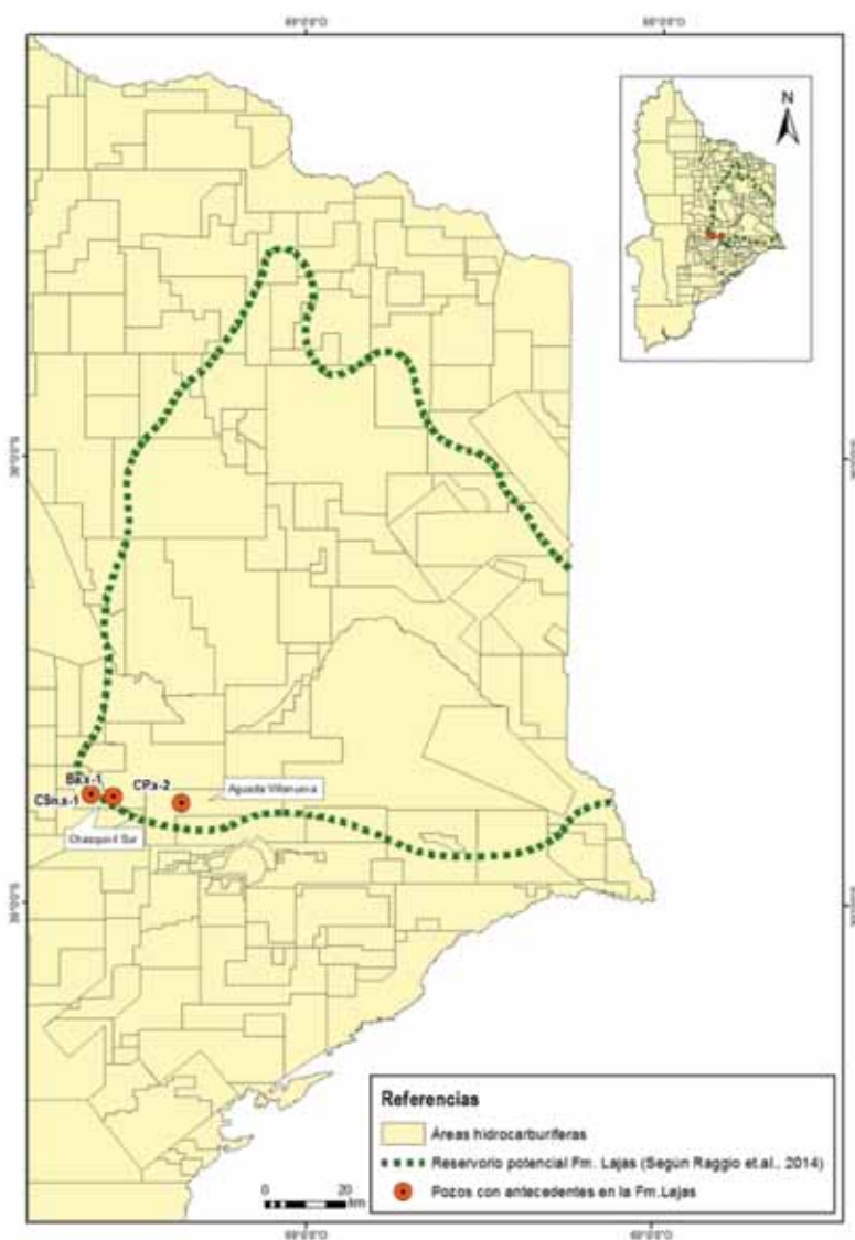
Figura 18. Ubicación de los pozos que detectaron gas en niveles de baja permeabilidad de la Formación Lajas y delimitación como reservorio tight propuesta por Raggio et al. (2014).
