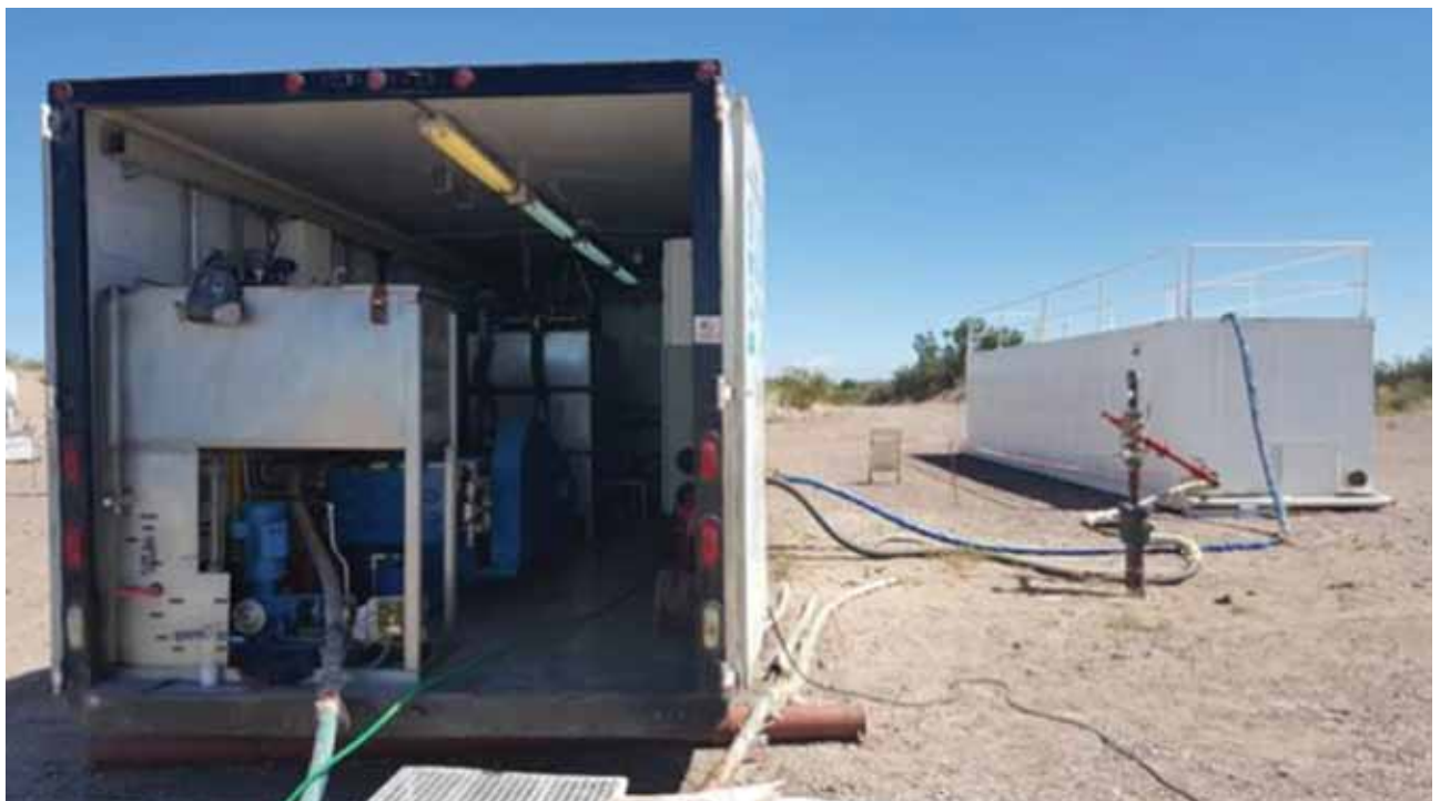
Figura 5. Circuito involucrado en el mezclado y el bombeo del gelificante.
