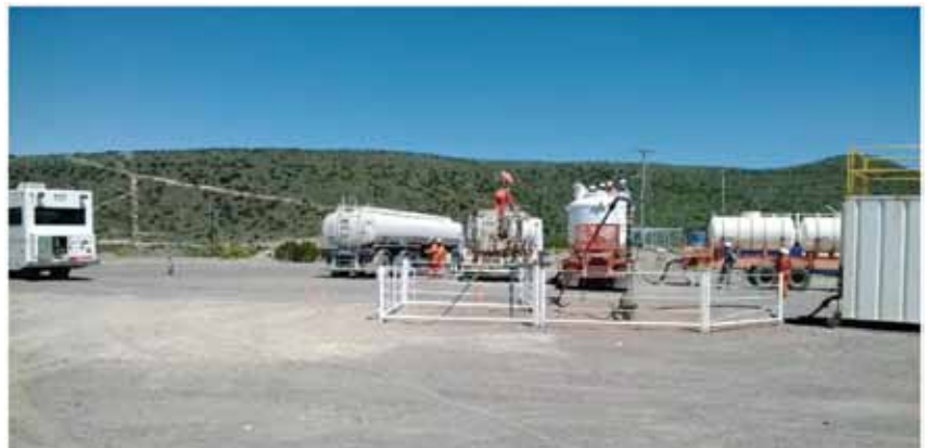
Figura 8. Equipamiento empleado para el bombeo del sistema casing líquido sin equipo de WO.
