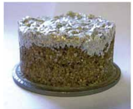
Figura 5. Ensayo de filtrado realizado con el sistema casing líquido con LCM en celda HPHT sobre medio altamente permeable (arena de fractura # 12/20).
