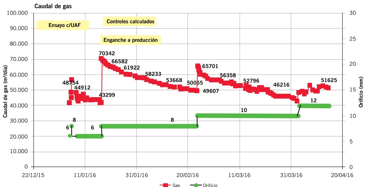
Figura 7. Producción del pozo piloto.
