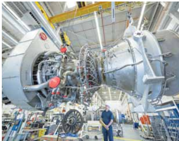
Turbina de gas Siemens “Industrial Trent 60” en etapa constructiva.
