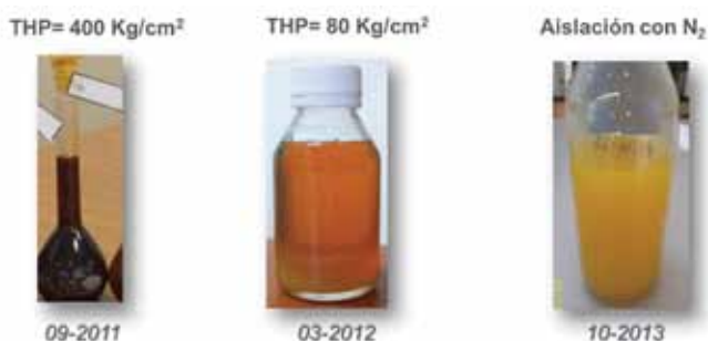
Figura 2. Deposición de parafinas y asfaltos (muestras del mismo pozo).
