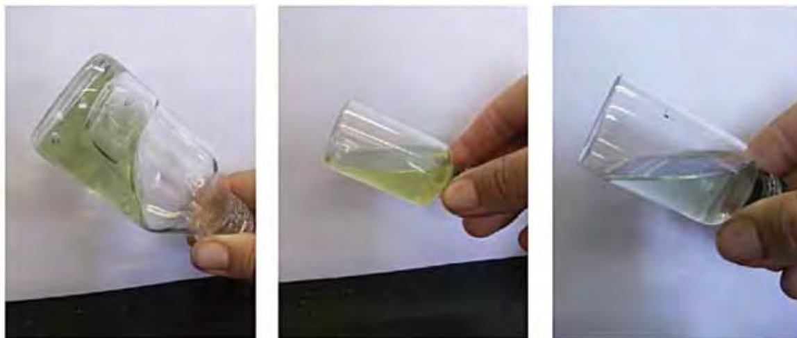
Figura 6. Tratamiento de disposición final (ruptura y neutralización) del sistema casing líquido.
