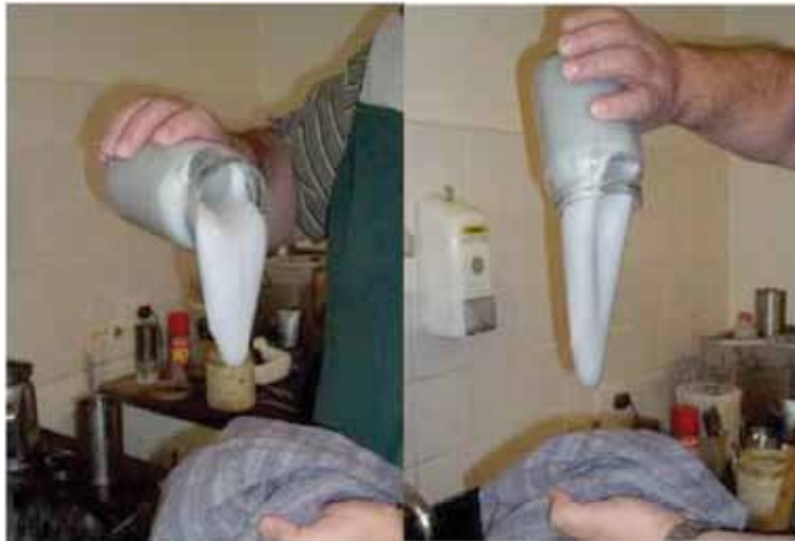
Figura 12. Aspecto de la muestra de campo del sistema casing líquido preparado a partir de polímero en emulsión, luego de 6 h de activación.
