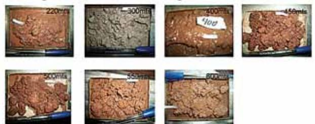
Figura 13. Muestras de derrumbes y recortes del pozo objetivo para el análisis morfológico de derrumbes de formación en tiempo real.
