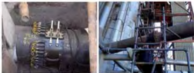
Ensayo de ondas guiadas en una cañería enterrada y otra aérea.
