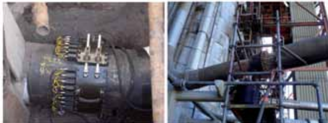
Ensayo de ondas guiadas en una cañería enterrada y otra aérea.
