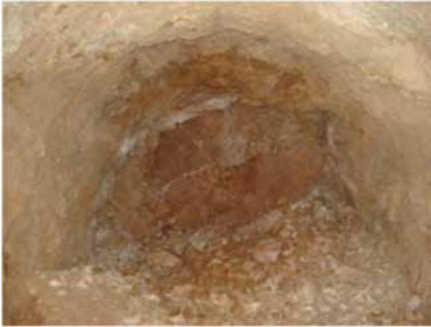
Figura 12. Frente de voladura realizado, donde se observa el material triturado en el piso.
