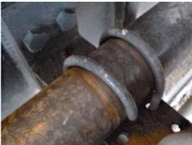
Figura 8. Desgaste por vibraciones.
