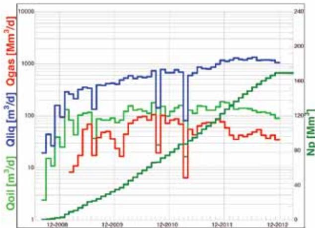
Figura 13. Producción resultante de los pozos profundos de la campaña de perforación *infill* a diciembre de 2012. En azul, fluido diario producido ( $m^3/d$ ). En verde claro, petróleo producido por día ( $m^3/d$ ). En rojo, gas producido por día ( $m^3/d$ ). En verde oscuro, petróleo producido acumulado ( $Mm^3$ ).
