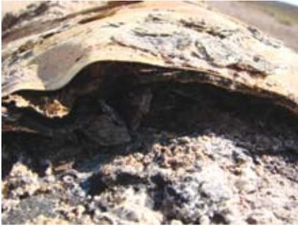
Figura 8. Celda de corrosión debajo del revestimiento despegado
