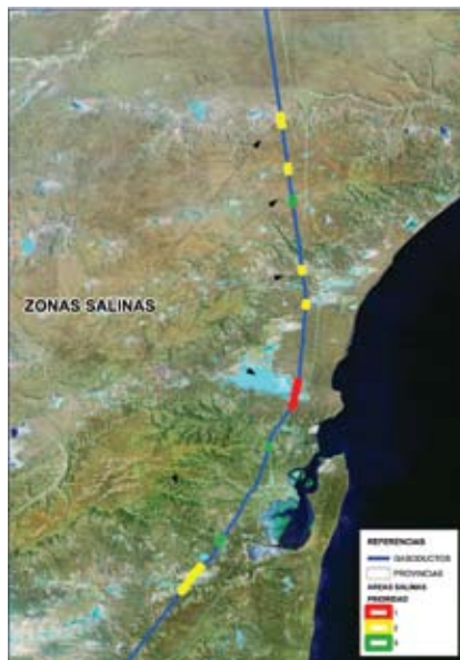
Figura 6. Identificación de zonas salinas para una sección de gasoducto
