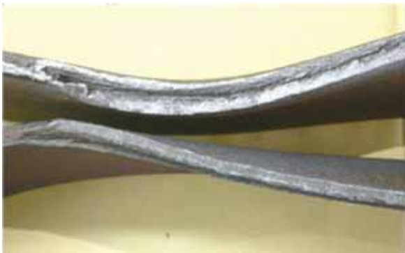
Figura 4. Defecto detectado en costura longitudinal. Defecto.
