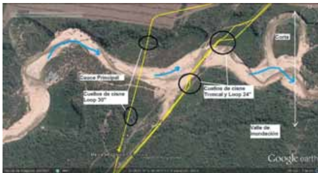
Figura 11. Cruce del Riacho Seco. Características de las trazas del río y de los gasoductos según las características constructivas de cada uno.
