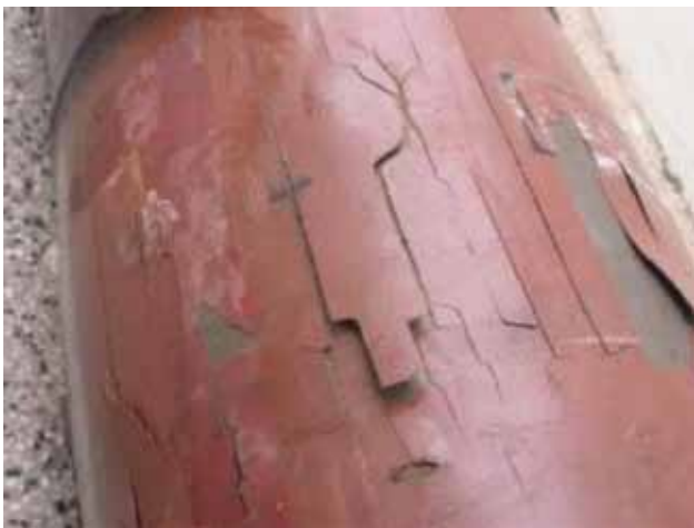
Figura 26. Muestra 1, posensayo. Debonding del coating caño B debido a la deformación plástica.
