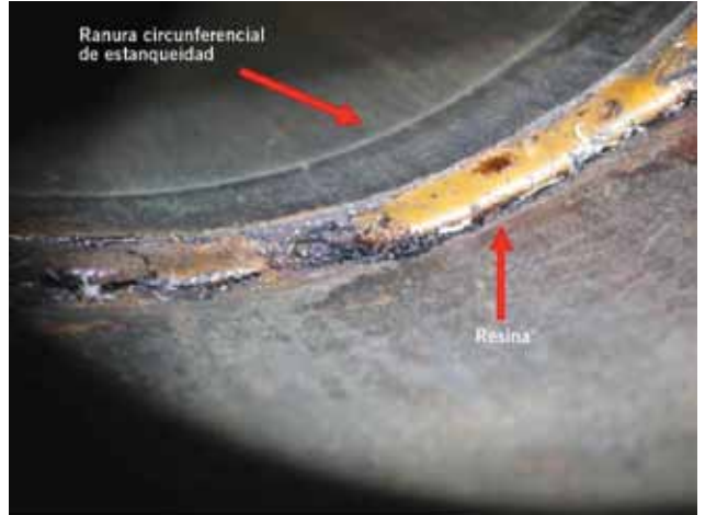
Figura 12. Remanentes de resina epoxi con desprendimiento en el borde 2A. Detrás, el pliegue de la ranura de almacenamiento de resina.
