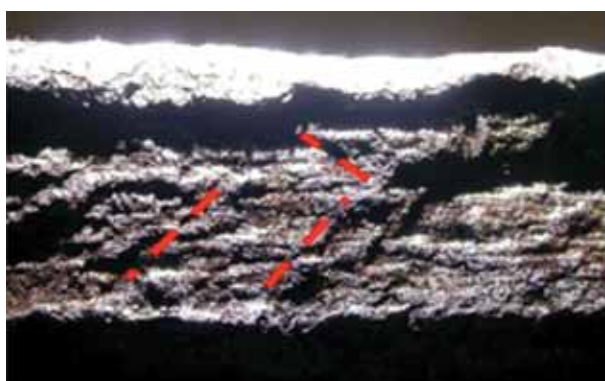
Figura 5. Chevrones identificados en laboratorio. Chevrones.
