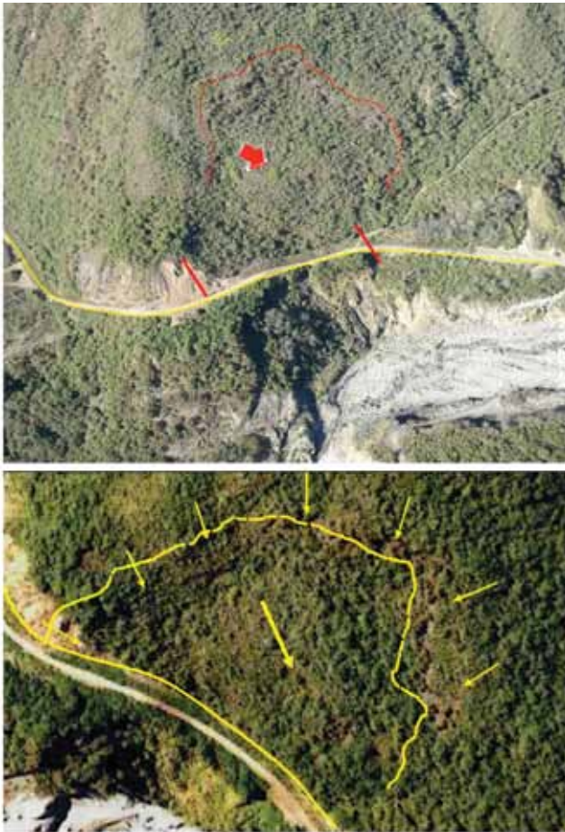
Figura 10. Arriba imagen 2016 (vista aéreo) donde se observa la cicatriz antigua de la escarpa de falla. La zona delimitada con líneas rojas indica la zona con movimiento. Abajo fotografía aérea (2002) que muestra un detalle de la zona del talud deslizado.
