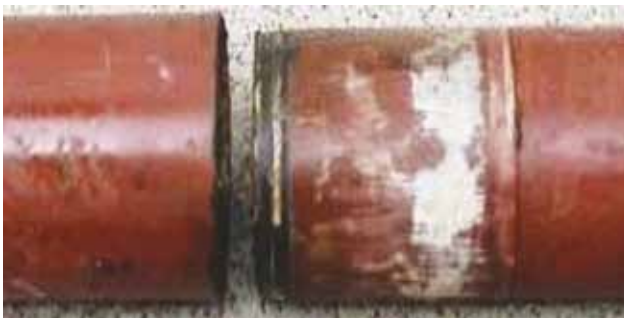
Figura 25. Muestra 1, posensayo. Separación de la junta.
