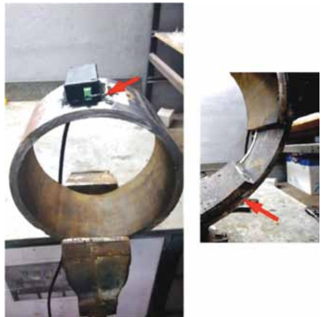
Figura 31. Junta embonada de 8". Instrumentación y corte de sector interno de sector. Virola del plano medio de la junta.
