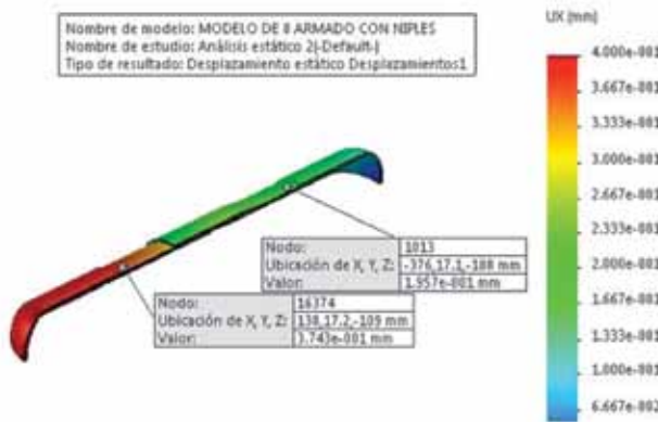
Figura 30. Modelado desplazamiento debido a presión interna. [20 MPa y tensiones residuales de zunchado]. Desplazamiento relativo entre los puntos de medición de 0,18 mm.
