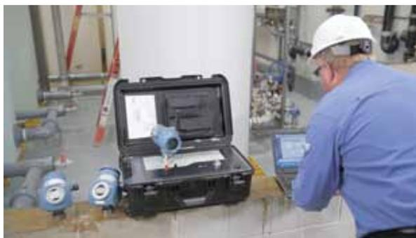
Con el nuevo servicio que ofrece Emerson, los técnicos se trasladan a las instalaciones del usuario y realizan la verificación sin tener que interrumpir la operación normal. La verificación de exactitud en cinco puntos se realiza usando el hardware de calibración con trazabilidad de estándares reconocidos. Además de verificar la exactitud y de hacer cualquier ajuste necesario, se evalúa la condición y configuración del instrumento de nivel GWR para asegurar un óptimo funcionamiento.
