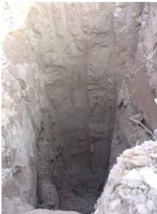
Foto 4. Sondeo en búsqueda de niveles de contaminación.
