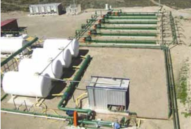
posee una salinidad equivalente de 15.000 ppm de NaCl, y se utilizan 1200 ppm de poliacrilamida para generar una viscosidad objetivo de 25 cp. Actualmente, por un período prolongado, estamos trabajando con 40/50 cp.
