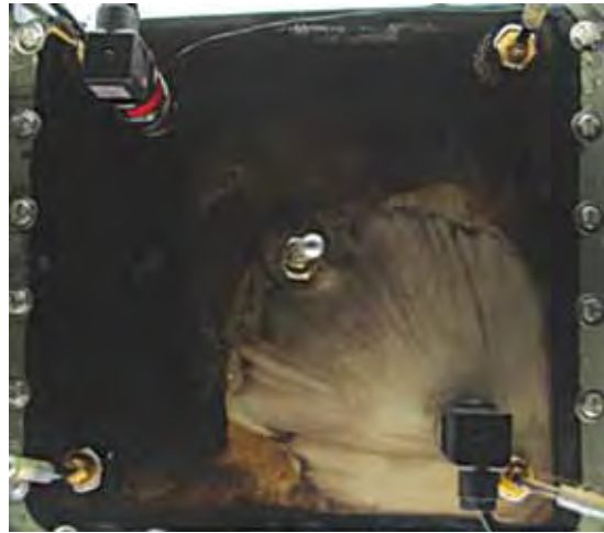
Visualización del frente de avance durante la inyección de ASP en una celda saturada inicialmente con petróleo.
