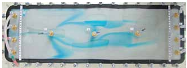
Visualización de trazadores en un medio poroso heterogéneo.
