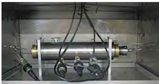
Celda triaxial desarrollada localmente para ensayos con polímeros. Permite aumentar la longitud de la muestra de roca y el tiempo de residencia de los fluidos.
