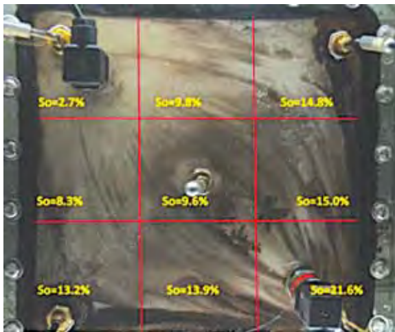
Estudio de inyección de polímero en celdas visuales. Al final del ensayo se desarma la celda y se miden las saturaciones de petróleo en cada uno de los sectores en que se dividió la misma.
