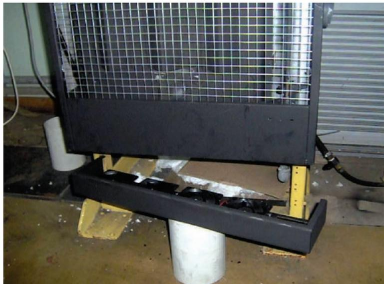
Figura 1b): Detalle del montaje de cuatro ventiladores para la convección forzada.
