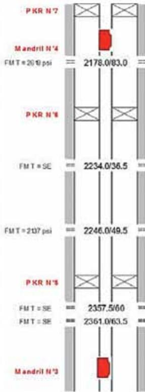
Figura 18. Pozo-4-Zonas ciegas entre mandriles productores.
